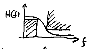
Toleranzschema für |H(j\omega)| und Approximationsfkt.
