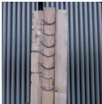
Nagelverbindung: Prüfkörper nach einem Tragfähigkeitsversuch.
