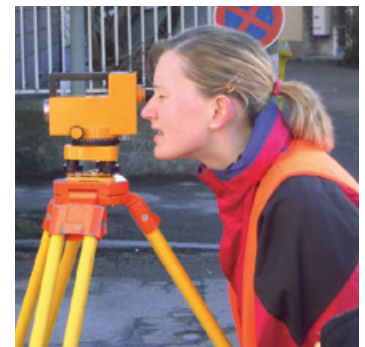
Wie ist wohl der Höhenunterschied? Eine Studentin beim Streckennivellement.
