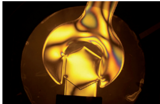
Sichtbar gemachte Kräfte in einem Bauteil.
