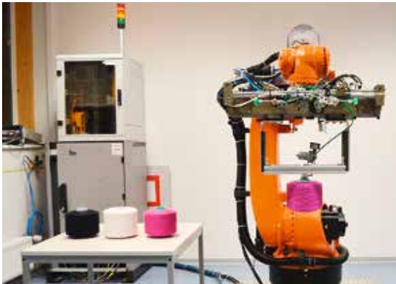
Abbildung 1: Testaufbau mit Garnaufnahme unter der Deckenkamera auf der linken Seite und einem Ablagetisch zur farblich korrekten Verpackung auf der rechten Seite.
