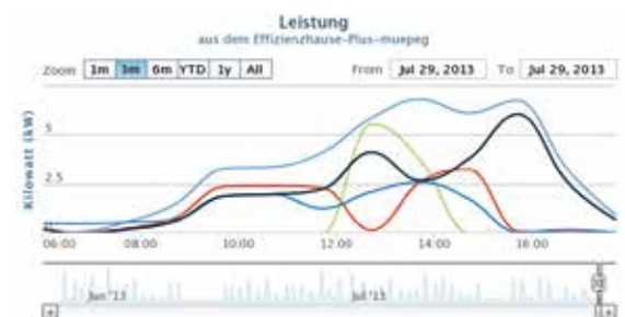
Abb. 2: Internetauswertung von Stromerzeugung aus Fotovoltaik, Beladung von Batteriespeicher und E-Mobilität
