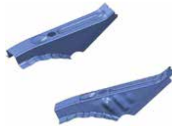
Abbildung 5: Tiefziehteil- Demonstrator; oben: Ideale CAD- Geometrie, unten: mit überzeichnet dargestellter Faltenbildung.
