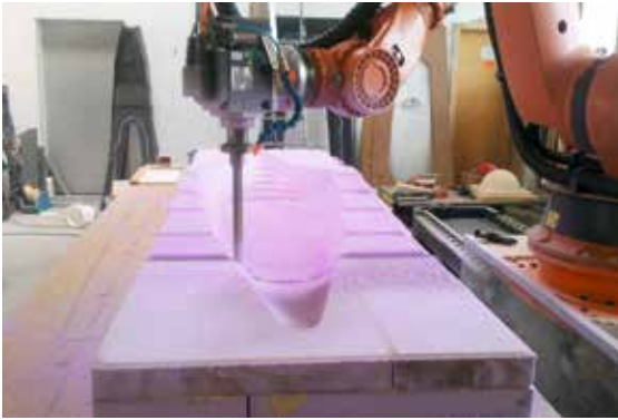
Abbildung 6: Fräsen der Negativform mittels Portalroboter.
