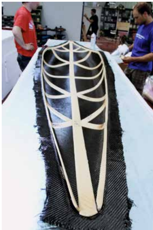
Abbildung 4: Rippenstruktur im Unterschiff.
