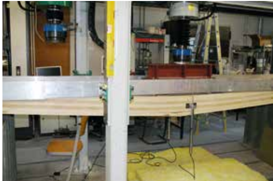
Abbildung 5: Versuch zur Ermittlung der Biegefestigkeit von Brettsperholzbauteilen.
