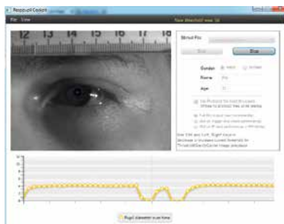
Abbildung 6: Screenshot der fertigen Anwendung während einer Messung. Die Auswertung des Pupillendurchmessers erfolgt dabei in Echtzeit
