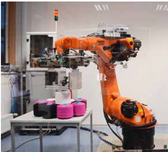
Abbildung 3: Bildgeführte Garnaufnahme mit Druckluft-Innengreifer vom Abnahmetisch.
