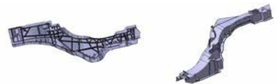
Abbildung 2: Demonstratorbauteil aus Aluminium-Druckguss „Verbindungsteil Längsträger-Schweller“ (Quelle: Audi).
