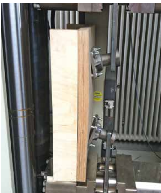
Abbildung 3: Nocken-Aufhängung nach Erreichen der Höchstlast.
