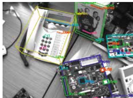
Abbildung 1: Die vom MARS-System erkannten Objekte werden lagerichtig markiert, wobei auch Details eines Objektes, wie zum Beispiel die Anschlüsse des Evaluations-Boards (unten), farblich gekennzeichnet und aussagekräftig beschriftet werden.
