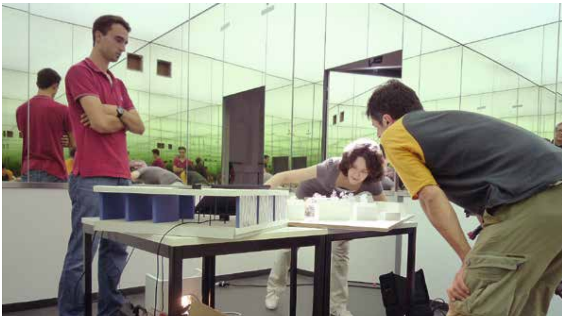
Messung an einem Architektur-Modell im neuen Tageslichthimmel
