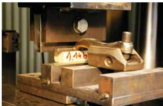
Abbildung 1: Prüfung von Bohrkernen (links: Prüfvorrichtung, rechts: Scherprobe nach dem Versuch).
