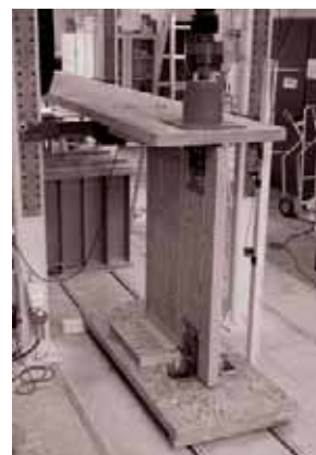
Bild 16: Prüfkörper für Knickversuch
