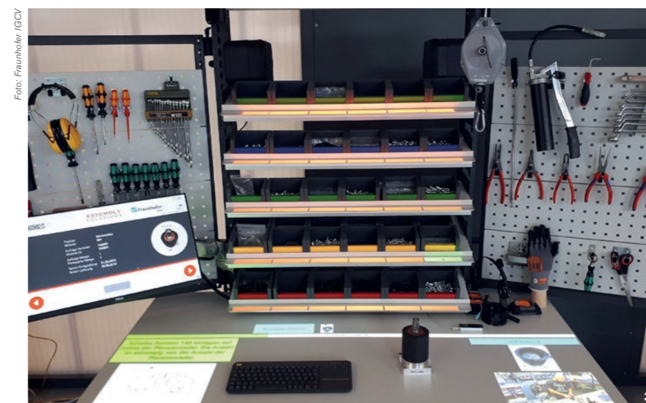
3 Demonstrator für den standardisierten Montagearbeitsplatz.
