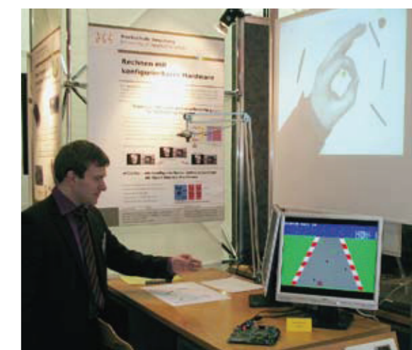
Abb. 5: Stand auf der embedded world 2010: Zu sehen ist ein halb-virtuelles Pong-Spiel. Die „intelligente Kamera“ nimmt das Spielfeld und die Hände des Spielers auf und blendet dann den Ball und den Spielstand zusätzlich in das Monitor-Bild ein. Das System ist komplett innerhalb eines FPGA-Bausteins realisiert, welcher sich in dem Kameramodul befindet.
