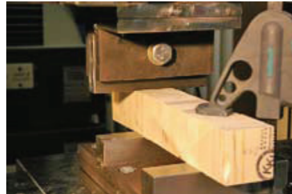
Abb. 1a: Eingebauter Probekörper.
