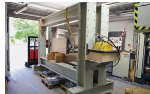
Abb. 4: Prüfrahm mit eingebautem Prüfkörper.
