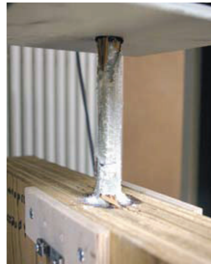
Abb. 3b: Versagen der Klebebindung.
