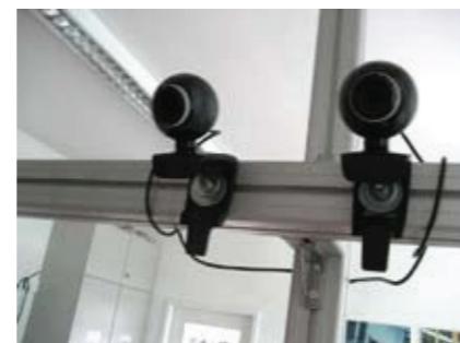
Abb. 2: Webcams als 3D-Überwachungssensor
