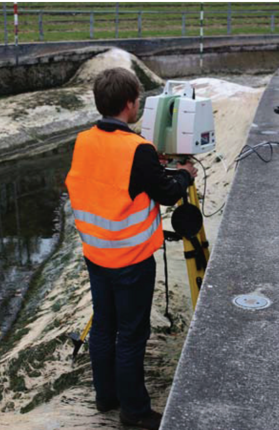
Vermessungsarbeiten am Eiskanal mit modernster Lasermesstechnik im Herbst 2010.
