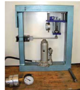
Experimentierkasten: Versuchsaufbau zur Messung von Auflagerreaktionen. Foto: Eugen Benks
