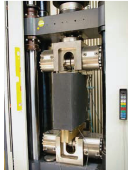
Abb. 3a: Klimatisierter Probekörper während der Prüfung.
