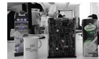
Abb. 4: Erkennung natürlicher Merkmale im Triokulus Projekt: Die farbigen Kreise markieren automatisch erkannte typische Merkmale dreier zuvor gespeicherter Objekte. Trotz der schwierigen Umgebung (z. B. Personen und Gegenstände im Hintergrund) gab es hier praktisch keine Erkennungsfehler.
