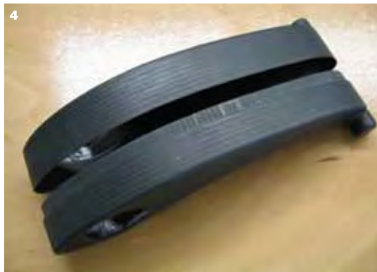
4 Trägerstruktur in CFK/Metall-Mischbauweise in Halbschalenbauweise vor der Verklebung.
