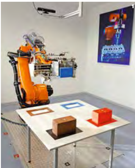
1 MRK-Applikation mit „KUKA KR 30HA“ Roboter und darüber angebrachtem 3D-Kamerasystem (Microsoft Kinect).
