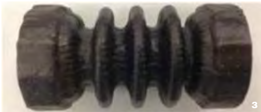
3 Prototyp für die Wellenkupplung in Prepreg-Bauweise.
