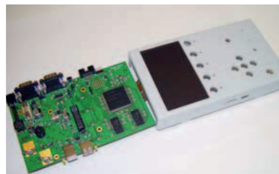
Abb. 5: Die Bauteilseite. Der große quadratische Baustein ist der LPC2478 Mikrocontroller. Darunter sind die zwei SDRAMs. Zwischen der Platine und dem Gehäuse ist das flexible Anschlusskabel des TFT-Displays. Die Platine wird in das Gehäuse eingeschwenkt.
