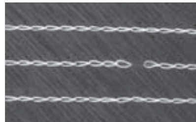
Abb. 7b: CFK-Trockenfasergelege bei Beobachtung mit optimierter schmalbandiger LED-Beleuchtungsanordnung.
