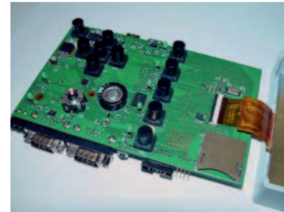
Abb. 6: Auf der Rückseite sind die mechanischen Bedienelemente aufgelötet. Sie passen genau durch die Löcher im Gehäuse. Rechts unten auf der Platine ist die Halterung für die MMC/SD-Karte. Das runde Bauelement in der Mitte ist ein Kondensator zur Notstromversorgung. Links daneben ist der Multifunktionschalter.
