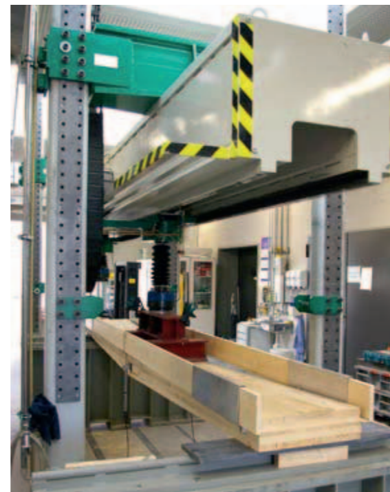
Abb. 2: Drei-Punkt Biegeversuch bei Holzwerkstoffen zur Ermittlung der Tragkraftreserven am KKI.
