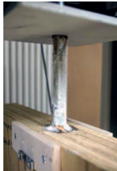
Abb. 4b: Versagen der Klebeverbindung.
