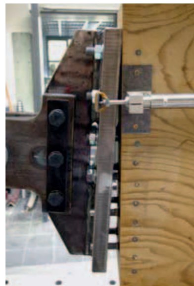
Abb. 5b: Versagensform des Anschlusses.
