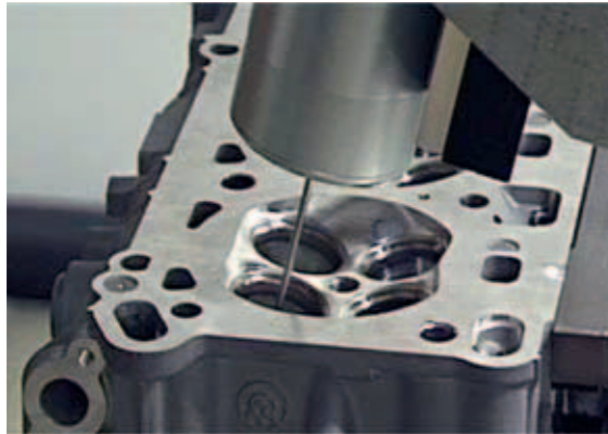
Abb. 10: Optische Messnadel beim Eintauchvorgang in eine Ventileinführung.
