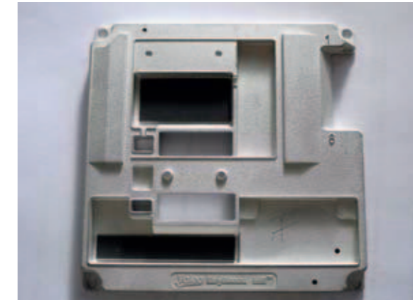
Abb. 4: Kunststoffschale als Funktionsträger und Gehäuse einer mechatronischen Komponente für den Automobilbau. In die Einbettungen werden dämpfende und isolierende Kunststoffeinlagen eingebracht, deren korrekte Bestückung im Anschluss mit Hilfe eines Kameraaufbaus und geeigneter Analysesoftware im Fertigungsprozess optisch geprüft wird.
