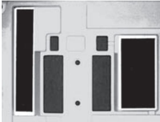
Abb. 5: Prüfmessungen im Zuge der Vorentwicklung eines vollautomatisierten optischen Inspektionssystems zur Überwachung eines Ablege- und Klebprozesses im Zuge der automatisierten Montage von elektronischen Sensorsystemen für den Automobilbau.
