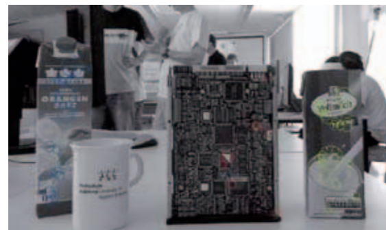
Abb. 1: Erkennung natürlicher Merkmale. Die farbigen Kreise markieren automatisch erkannte typische Merkmale dreier zuvor gespeicherter Objekte. Trotz der schwierigen Umgebung (z. B. Personen und Gegenstände im Hintergrund) gab es hier praktisch keine Erkennungsfehler.
