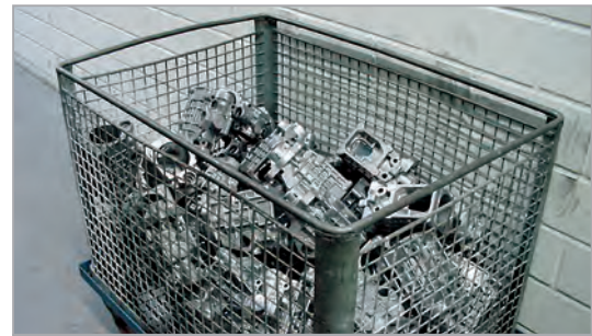
Bild 1: Bunkern von Gussteilen in einer Gitterbox
