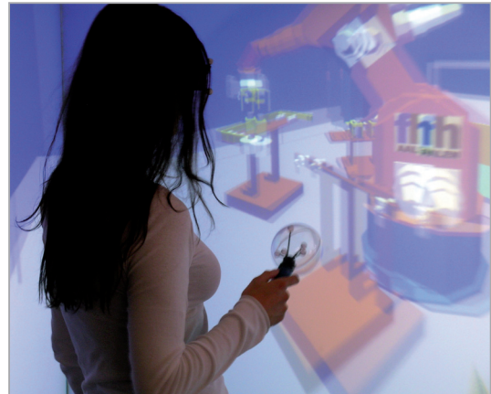
Bild 1: Digitale Prozessvisualisierung in stereoskopischer Darstellung (Objekte erscheinen ohne Brille doppelt)
