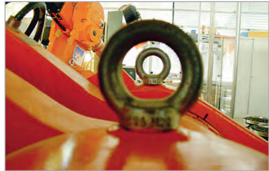
Bild 1: Lastösen zur Handhabung eines Roboters
