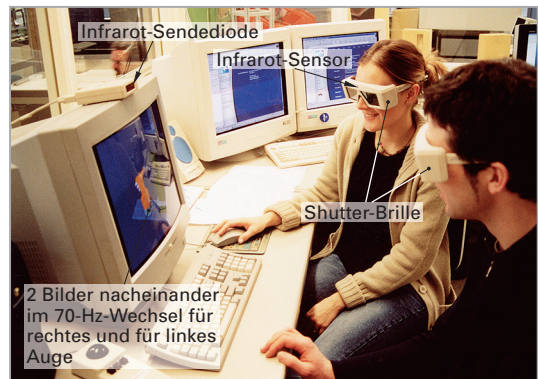
Bild 2: Stereoskopisches Sehen mit Shutterbrille
