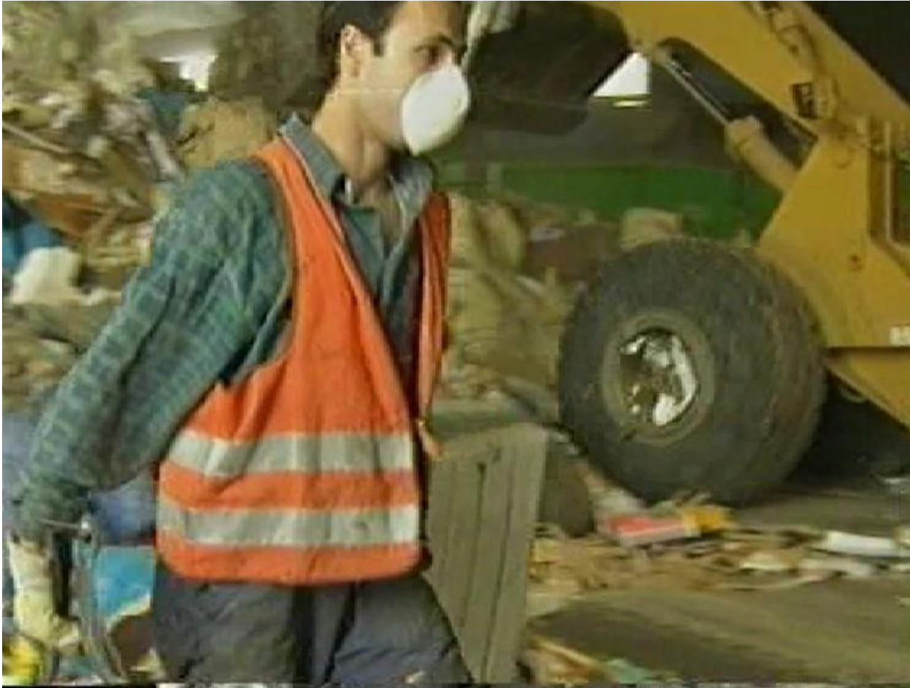
Bild2: Arbeiter beim Transport der „Störstoffe“, dahinter Radlader beim Beschicken der Aufgabebehälter
