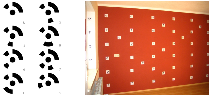
Abb. 3: links: Zielmarken für die automatische Kamerakalibrierung mit der Software Elcovision 10; rechts: Aufgebautes Testfeld
