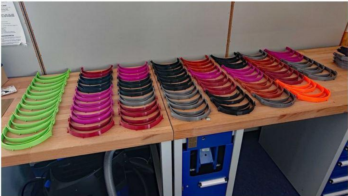
250 Rundbögen für die Faceshields entstanden im FabLab der Fakultät für Informatik. Foto: Hochschule Augsburg
