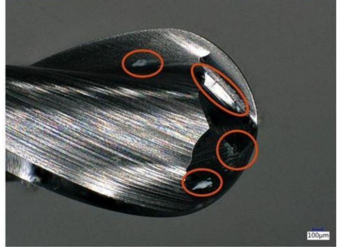
Rechts: Fräser Zz nach dem 3. Einsatz
