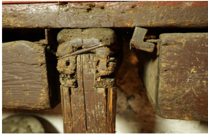
links und rechts: Detailaufnahme Werkbank, Aufhängung Schubladen und Verbindung Mittelpfosten mit Werkplatte
