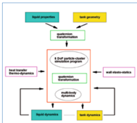
Abb.1(links): Prozesskette „Fluid-Struktur Interaktion“ mit dem Particle-Cluster Ansatz als Kernelement.
