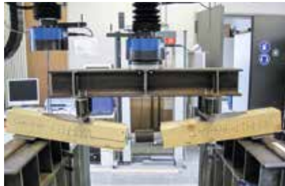
Abb. 4: Typ Royal im Biegeversuch zur Ermittlung der Momenten-tragfähigkeit.
