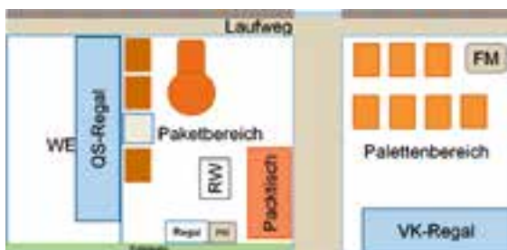
Abb.1: Anordnung Warenausgang Vorher.
