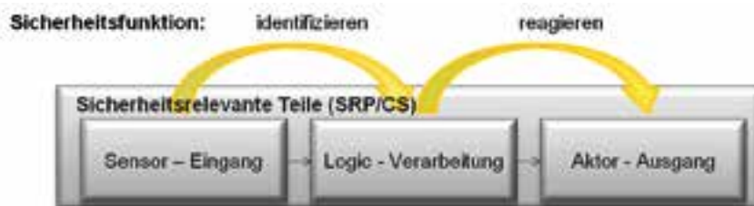
Prinzip eines Steuerungssystems.
