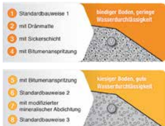
Abb. 4: realisierte technische Sicherungsmaßnahmen (Quelle: BASt).
