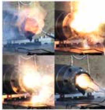
Abb. 3: Verschiedene Phasen des Anzündvorganges (Blick auf die Expansionsdüse).
