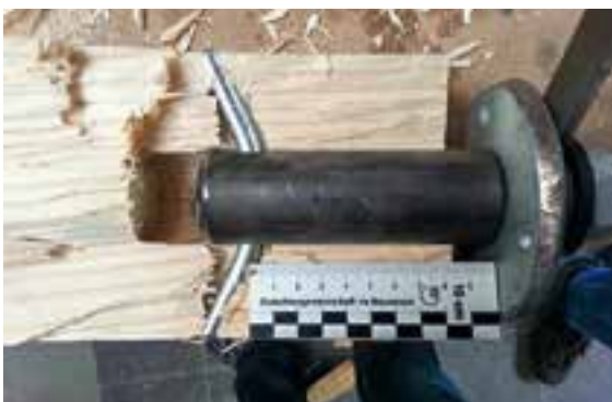
Abb. 2: Aufgetrennter Prüfkörper des Typs K1 nach einem Zugversuch.
