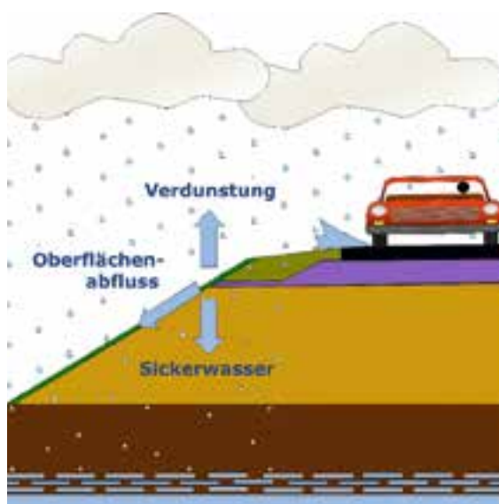
Abb. 1: Schematische Darstellung des Wasserhaushaltes an einer Straßenböschung (Quelle: BAST).
