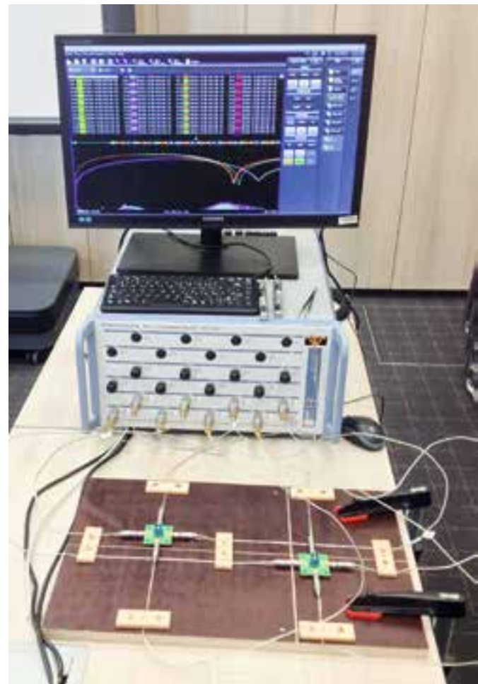
Abb.: Messaufbau zur Charakterisierung eines HSD-Kabels.
