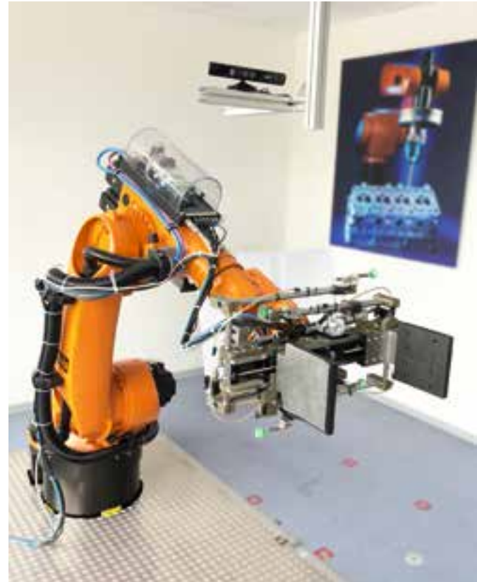
Abb.: KUKA KR 30HA Roboter mit darüber angebrachter Microsoft Kinect 3D-Kamera.
