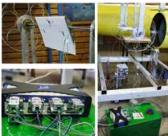
Abb. 10: Tragflügel mit DMS sowie strukturmehchanischer Aufbau im Windkanal.
