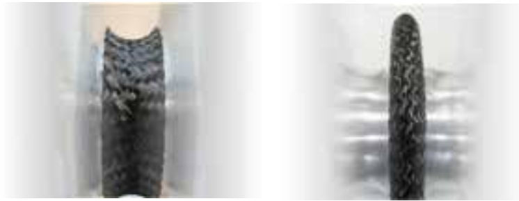
Abb. 4: Drapierversuche an Modellkerngeometrien mit Prepregsystemen.
