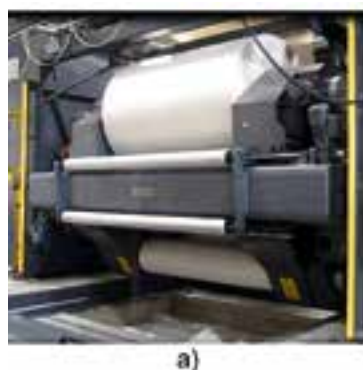
Abb. 1: Rollenwechsler zu industriellen Materialabwicklung a) und „Pendeltänzer“ b). Bild c) zeigt einen grafischen Funktionsbaustein zur Überwachung eines Pendeltänzers.
