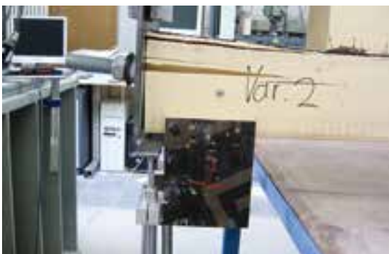
Abb. 3: Typ Vario im Querkraftversuch mit ausgeprägtem Querkzugversagen.
