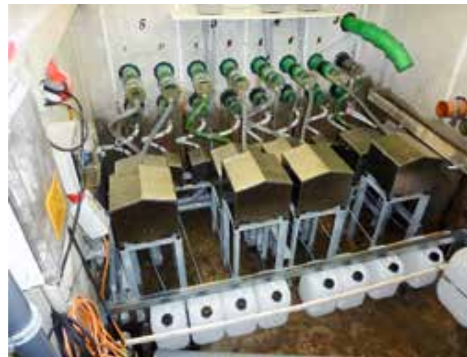
Abb. 5: Sickerwasserfassung und -messung im Keller der Messstation.
