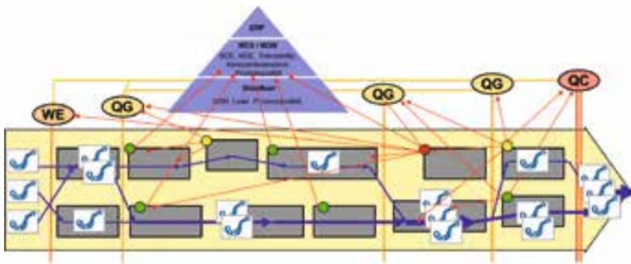
Abb. 4: Fertigungsfluss bei selbstorganisierter Produktion auf nicht von Beginn an definierten Pfaden mit ebenfalls sich selbst organisierendem vernetztem Quality Gate Management.
