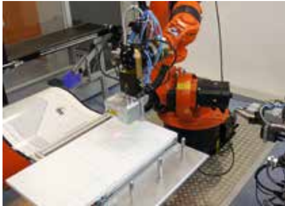
Abb. 3: Roboterzelle mit Laserscanner zur kennzahlbasierten Präzisionsvermessung von Klebstoffauftrag bei gleichzeitiger Selbstorganisation der Roboterführung und Verdichtung der Messdaten zu Echtzeit-Kennzahlen für Inline Prozessdiagnosen und Frühwarnfunktionen.
