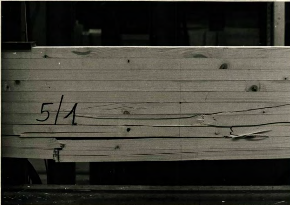
Bild 6.30: Versuchsträger 5/1 nach Erreichen der Höchstlast F_u = 81,8 \text{ kN}
