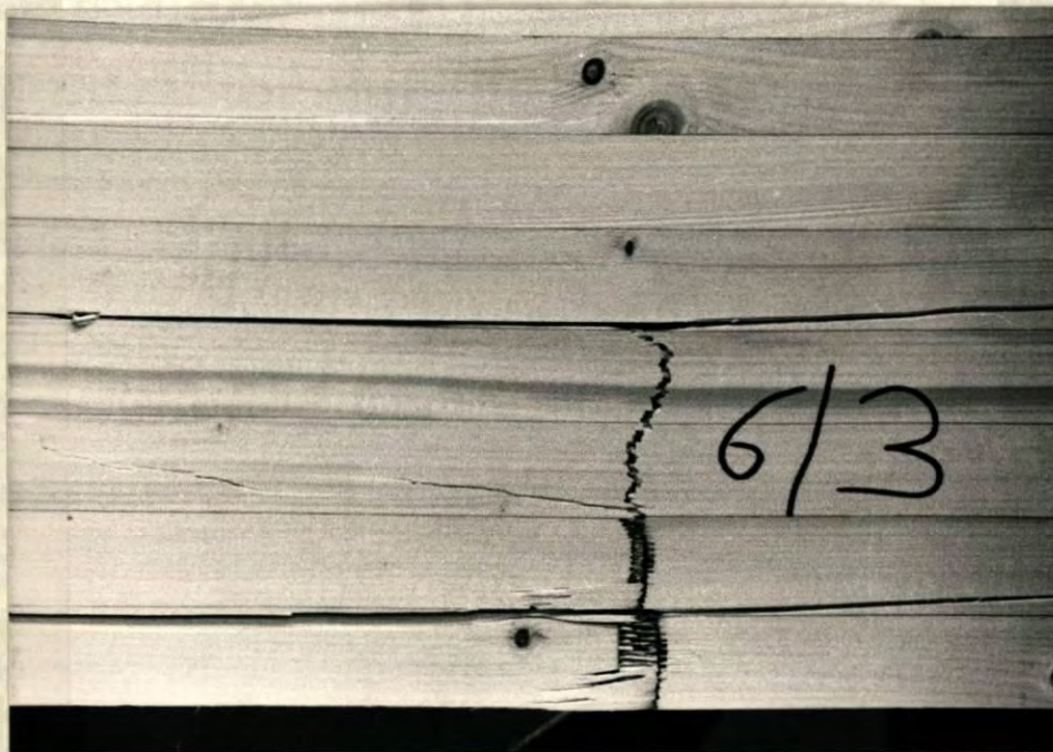
Bild 6.31: Versuchsträger 6/3 nach Erreichen der Höchstlast F_u = 77,1 \text{ kN}
