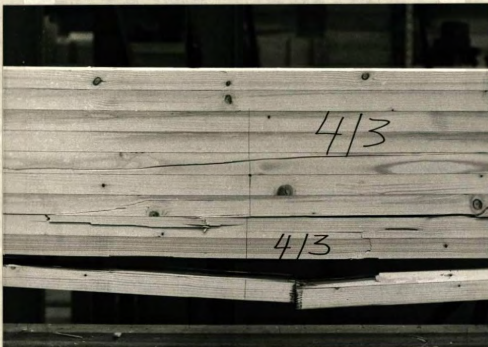
Bild 6.29: Versuchsträger 4/3 nach Erreichen der Höchstlast F_u = 88,7 \text{ kN}
