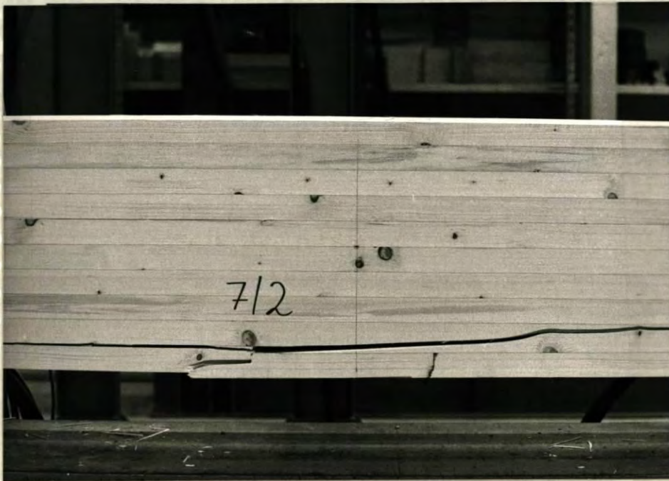
Bild 6.32: Versuchsträger 7/2 nach Erreichen der Höchstlast F_u = 74,2 kN
