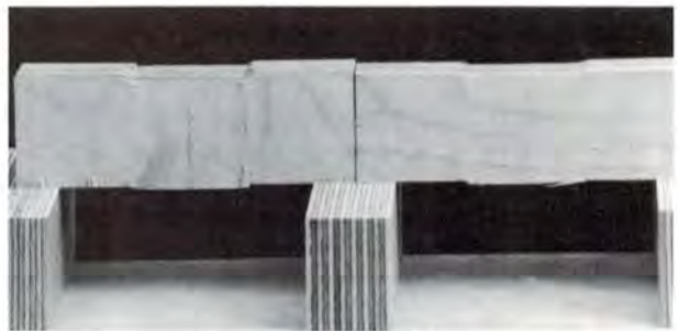
Bild 8. Scherbruch bei kleinen Proben Fig. 8. Shear failure of small test specimens
