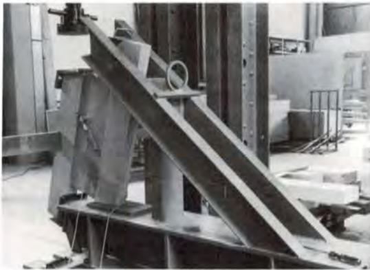
Bild 5. Prüfeinrichtung und eingebauter Prüfkörper Fig. 5. Test set-up with test specimen
