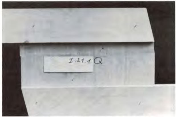
Bild 7. Scherbruch bei Deckfaser rechtwinklig zur Scherfläche Fig. 7. Shear failure perpendicular to face-grain
