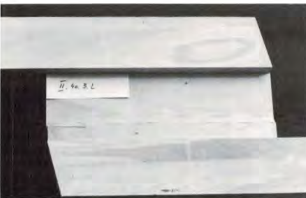
Bild 6. Scherbruch bei Deckfaser parallel zur Scherfläche Fig. 6. Shear failure parallel to face-grain
