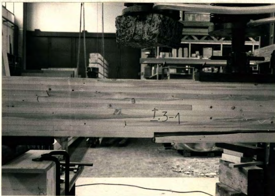
Bild 41: Bruchbild des Trägers I.3-1; Bruch von einer Keilzinkenverbindung außerhalb des Bereiches des Größtmomentes ausgehend
