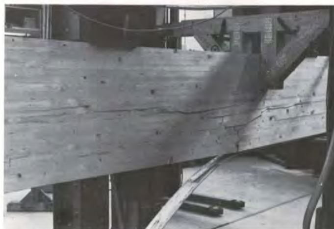
Bild 42: Typisches Bruchbild eines verstärkten Trägers mit abgeplatzter GVP-Lamelle
