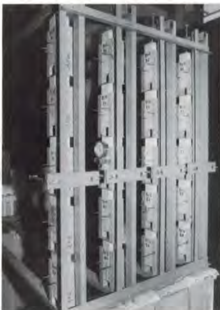
Bild 18: Vorrichtung für Scherkörper unter Langzeitbelastung, 1/100 Meßuhr in Meßstellung (Bildmitte).
