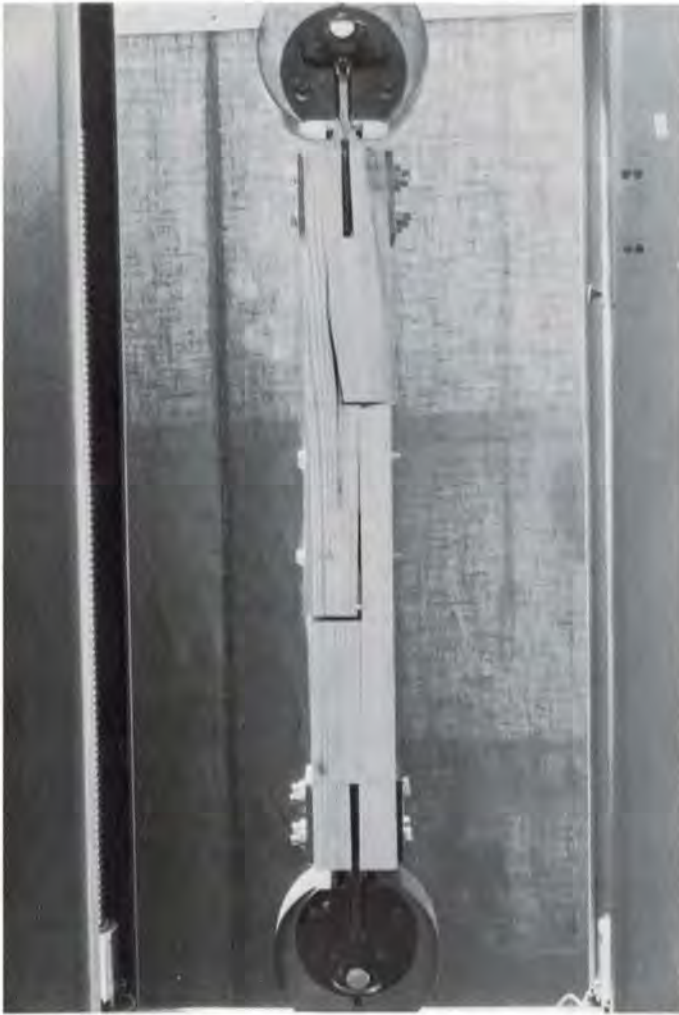
Bild 8: Hakenblattverbindung in der Prüfeinrichtung nach dem Versuch
