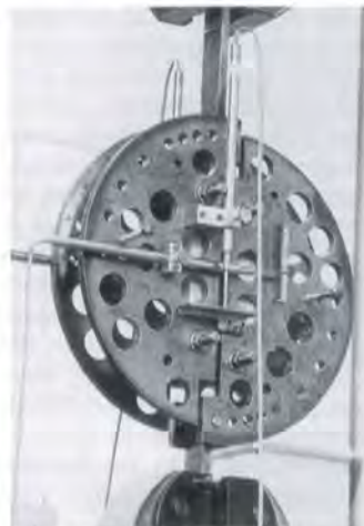
Bild 37: Vorrichtung zur Prüfung von Nagelverbindungen unter Beanspruchung auf Abscheren, Herausziehen oder einer Kombination beider Lastfälle
