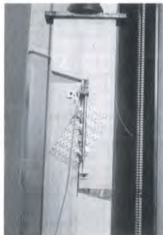
Bild 38: Druckscherkörper – Prüfung einer Nagelplattenverbindung
