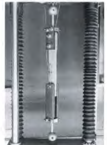
Bild 19: Versuchsanordnung bei einer Zugbelastung in Faserrichtung
