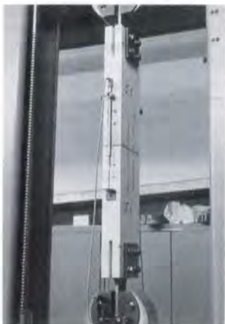
Bild 36: Zugscherkörper – Prüfung einer Stahlblech-Holz-Nagelverbindung
