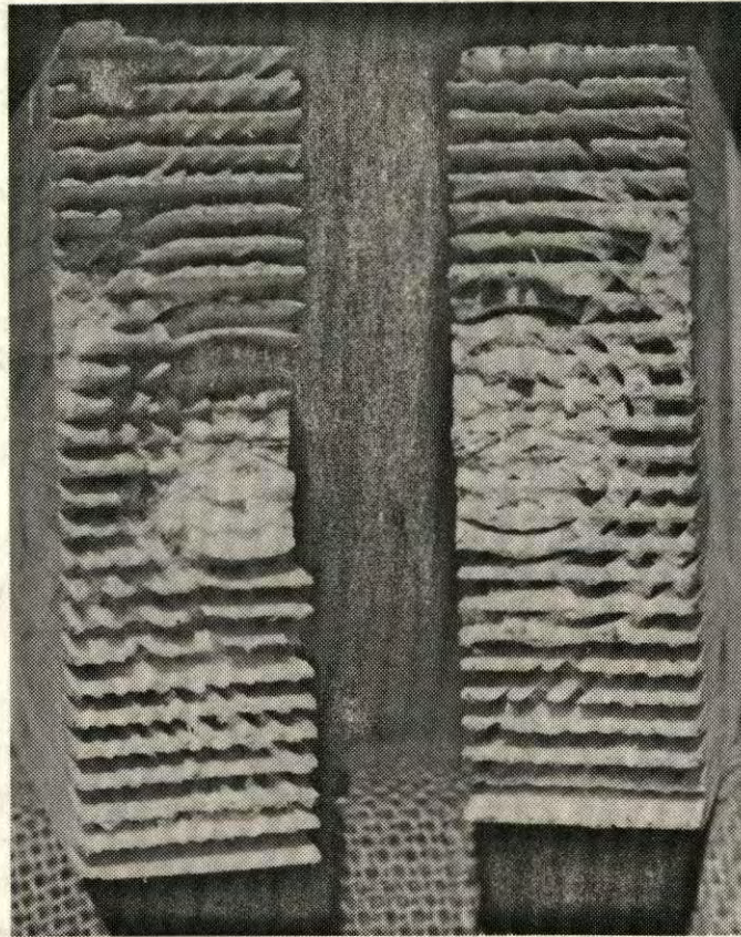
Bild 8.9: Typisches Bruchbild einer Keilzinkenverbindung mit Markröhre
