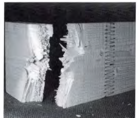
Bild 5: Schlecht ausgeführte Keilzinkenverbindung; schlechtes Ineinandergreifen der Zinken
