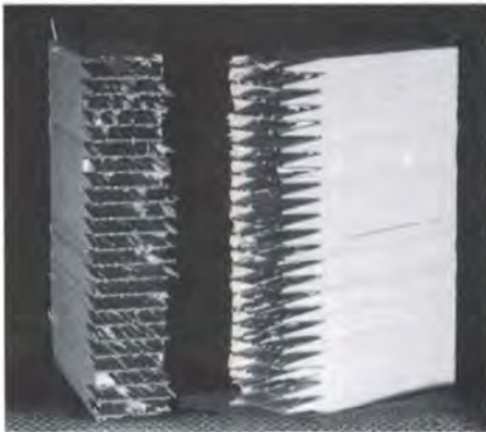
Bild 8: Ordnungsgemäße Keilzinkenverbindung mit 100%igem Keilzinkenversagen
