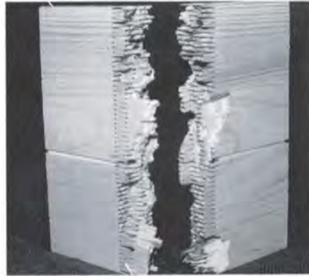
Bild 9: Keilzinkenverbindung mit überwiegenderem Holzversagen
