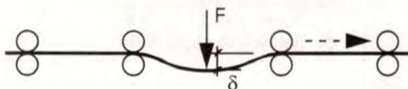
Bild 1: Systemskizze des Biegeverfahrens
