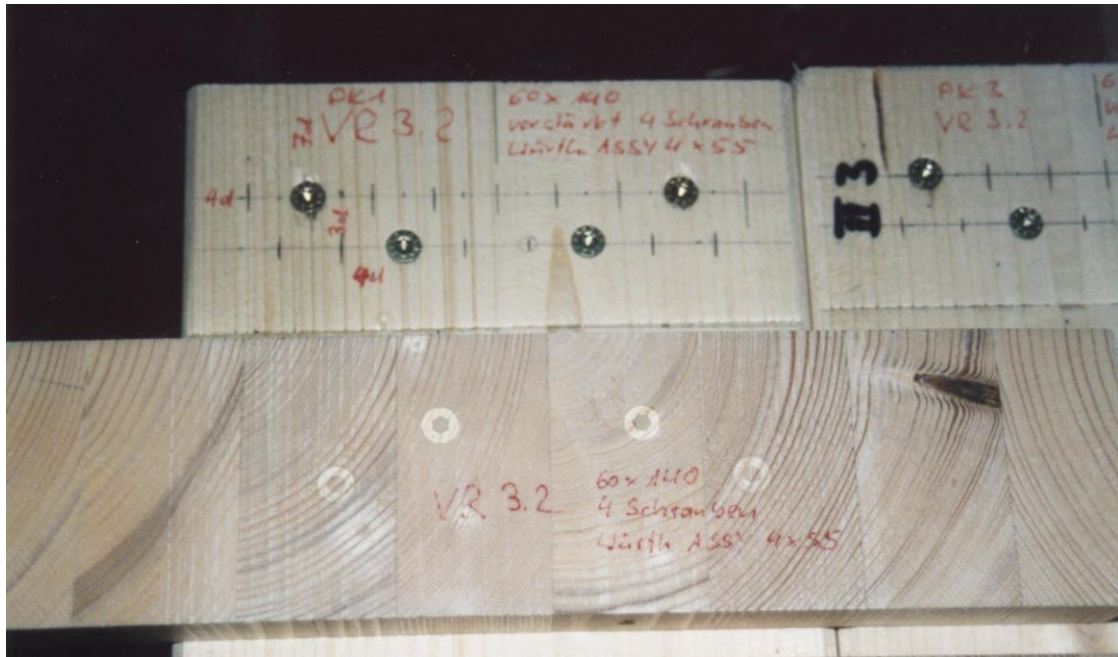
Bild 5.1-4 verstärkte Prüfkörper nach dem Versuch
