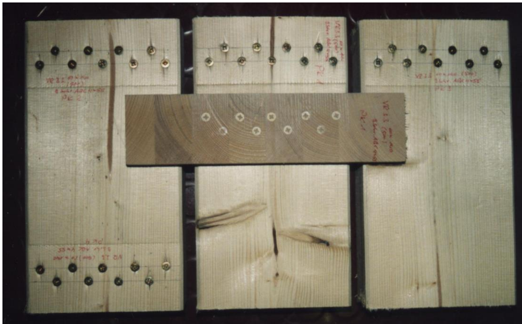
Bild 5.1-6 verstärkte Prüfkörper nach dem Versuch
