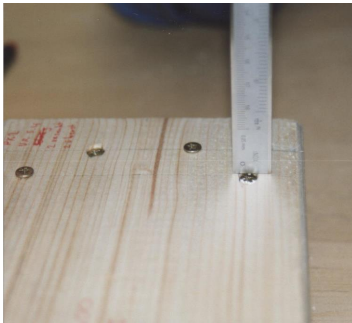
Bild 5.1-10 Prüfkörper mit versenkten und überstehenden Schraubenköpfen
