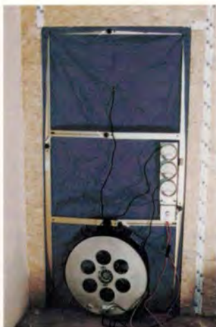
Bild 12: Blower-door-Prüfung: Ventilator mit Mess-Uhr im Türrahmen
