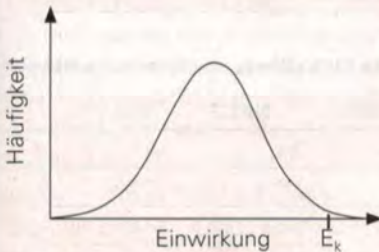
Bild 1: Häufigkeit einer Einwirkung und charakteristischer Wert E_k nach DIN 1055
