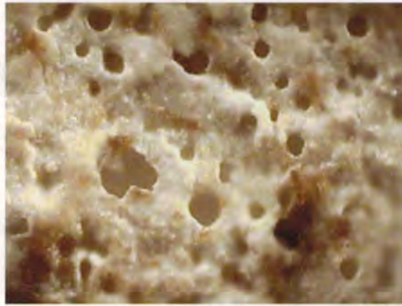
Bild 8: Die poröse Oberfläche eines wasserlöslichen Anstrichs
