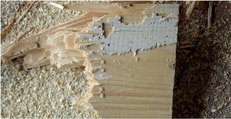
Beispiel für eine nicht ordnungsgemäße Klebung: Die Leimfuge ist zu dick, der Pressdruck war zu gering
