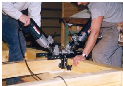
Bild 2 Setzgerät (Foto sfs-intec)
