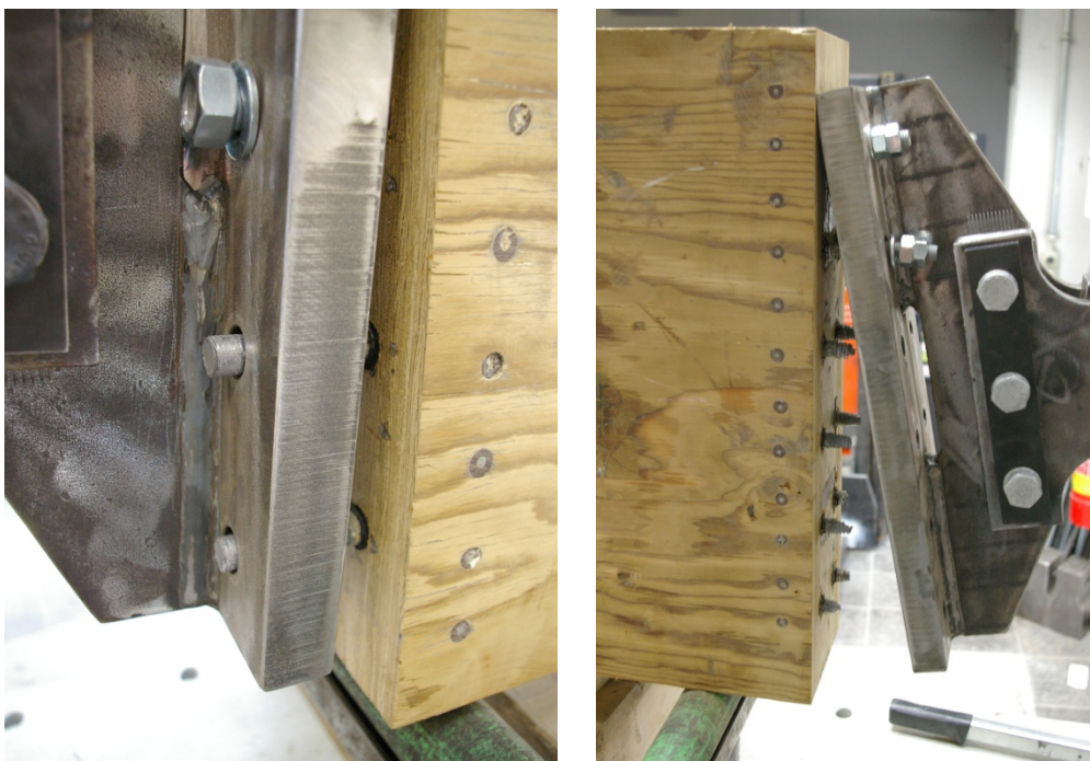
Abbildung 13: „Abstreifen“ der Muttern (links) und Zugversagen der Stangen (rechts)
