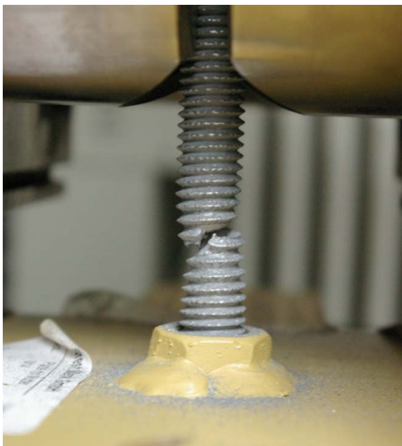
Abbildung 6: Prüfkörper mit Zugversagen der Gewindestange
