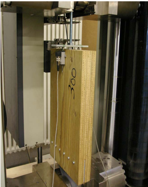
Abbildung 2: Prüfkörper mit 300 mm Einklebelänge
