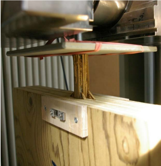
Abbildung 7: Prüfkörper mit Herausziehen der Gewindestange
