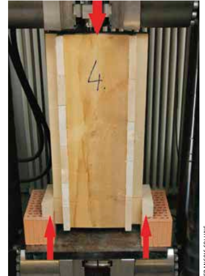
▶ Bild 3: Prüfkörper mit Bretterschalung als Zwischenschicht
