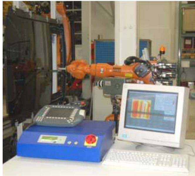
Beispielapplikation: zerstörungsfreie Prüfung einer Fahrzeugscheibeneinklebung
