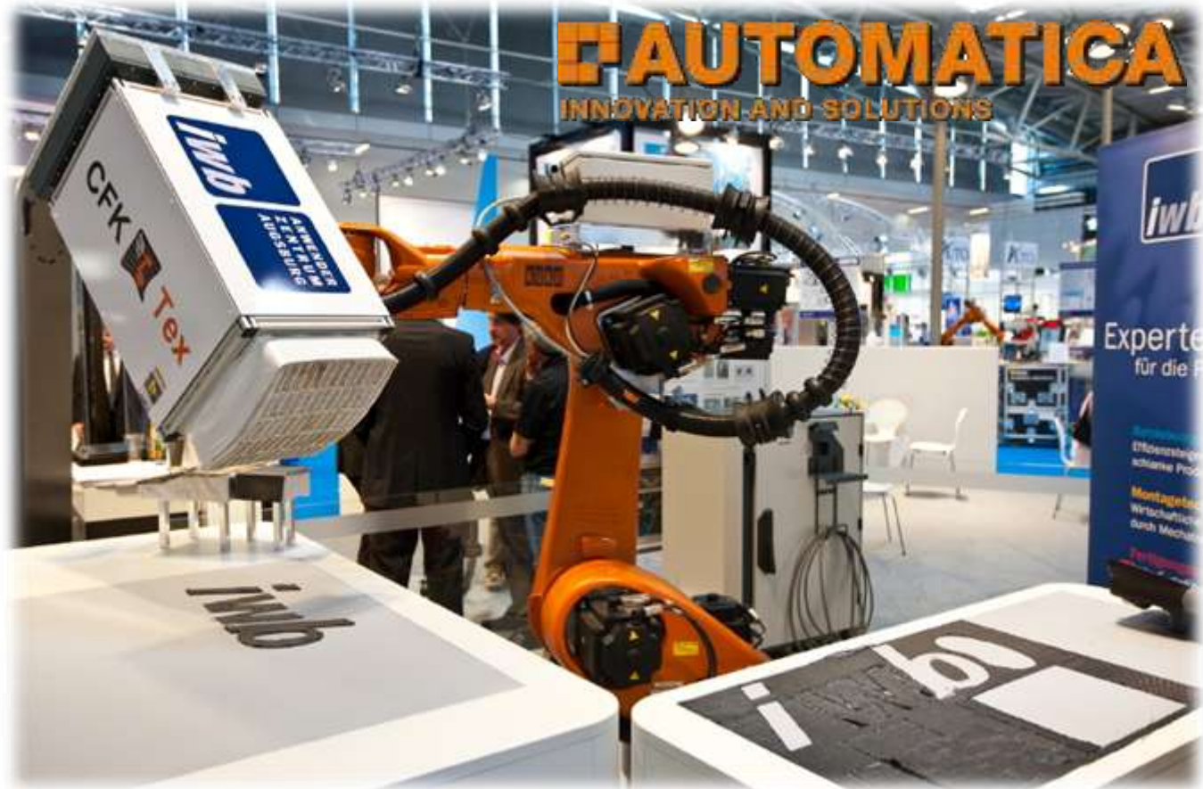
Doppel-End-Effektor zum Handhaben und Preformen : Präsentation AUTOMATICA 2010
