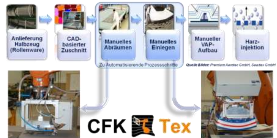
Industrieller Fertigungsprozess von CFK-Strukturen
